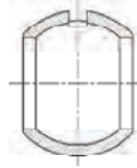
Detalhe da esfera para as bitolas de 2" a 6" Detail of the ball for size 2" up to 6" Detalle de la esfera para los tamaños 2" hasta 6"
